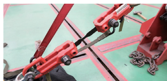
テストピースをクランプで固定して引く
